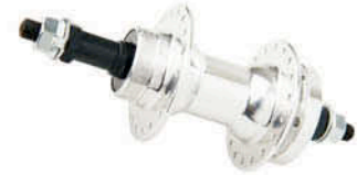
RD-130 (Disk) For MTB-Disk, Nut Type Alloy Body, 28H / 32H / 36H. Flange Space : 58mm Flange PCD : 58mm
